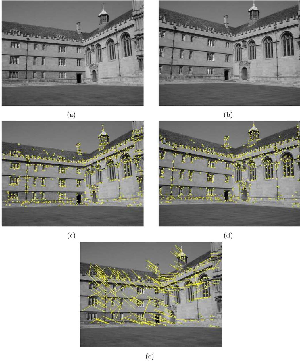
Figura 3.5: Cálculo Automático de correspondencias utilizando ZNCC (a) (b) Imágenes izquierda y derecha del Wadham College de la Universidad de Oxford. (c) (d) Esquinas detectadas. Hay poco mas de 600 esquinas detectadas en cada imagen. (e) 245 correspondencias encontradas utilizando ZNCC.
