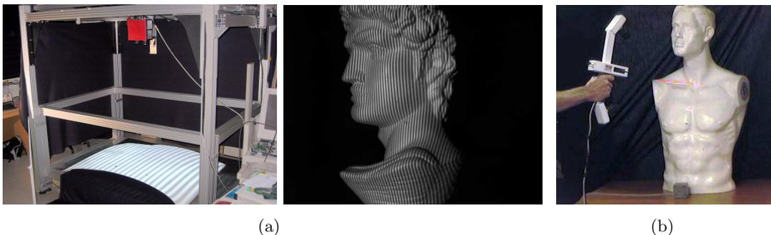
Figura 1.1: Métodos de reconstrucción. (a) Sistemas de luz estructurada. (b) Escáneres láser.
