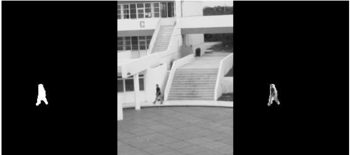
Figura 3.2: Ejemplo de la extracción de fondo de una imagen y su representación en una imagen binaria
