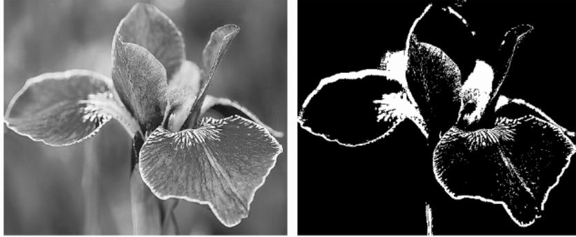
**Figura 2.9:** Resultado de aplicar el proceso de umbralización a una imagen con un umbral de 180. Los objetos por debajo de este umbral son degradados a cero mientras que los que están por arriba son establecidos en uno.
