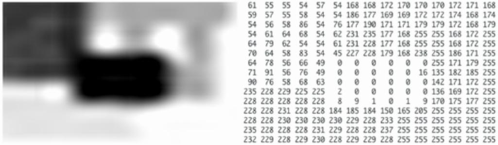
**Figura 2.5:** Los pixeles de una imagen en escala de grises son representados mediante valores enteros en el rango de 0 a 255. Donde 0 representa el nivel de gris negro y 255 el blanco.
