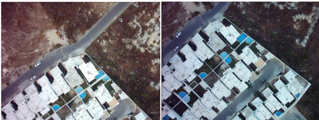
Figura 5.6: Dos imágenes con área de traslape suficiente y rotación de la cámara entre ambas
