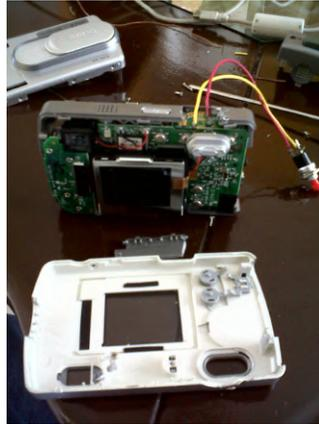
Figura 2.3: Cámara digital utilizada. Puede observarse que se manipuló para poder ser disparada por un dispositivo electrónico
