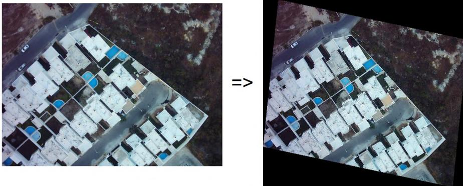
Figura 5.7: Aplicación de la matriz de homografía encontrada (prácticamente una rotación) a una de las imágenes de la secuencia
