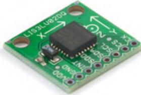
Figura 2.6: Tarjeta con acelerómetro LIS3LV02DQ de tres ejes con capacidad de medición de hasta  $\pm 6g$
