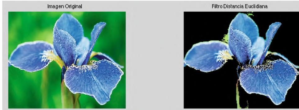
**Figura 2.8:** Segmentación del color azul usando la distancia euclidiana como métrica de distancia y un umbral de 0.5 para la comparación. Los pixeles cuya distancia excede el umbral fueron degradados al vector  $(0,0,0)$ , los que cumplían la condición conservaron su valor.
