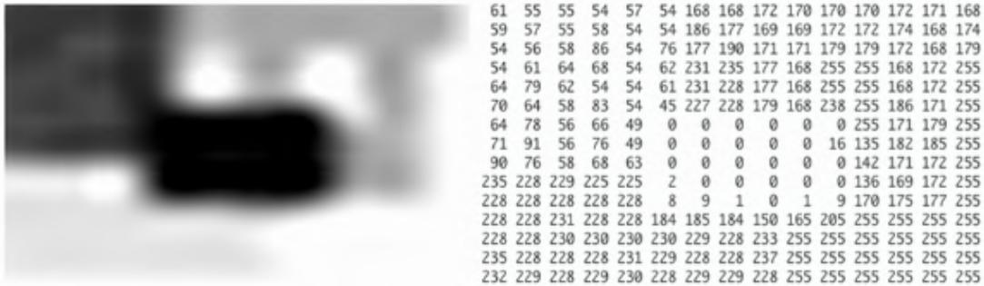
**Figura 2.4:** Los píxeles de una imagen en escala de grises son representados mediante valores enteros en el rango de 0 a 255. Donde 0 representa el nivel de gris negro y 255 el blanco.
