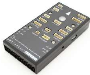
(a) Computadora de vuelo HK32Pilot.
