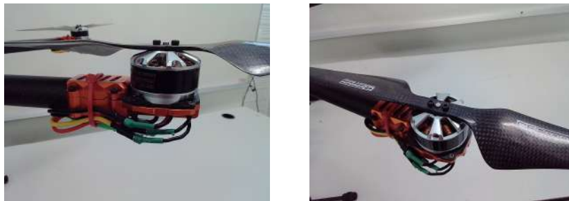
Figura 3.11: Montaje de motores MT4012 en el hexacóptero.
