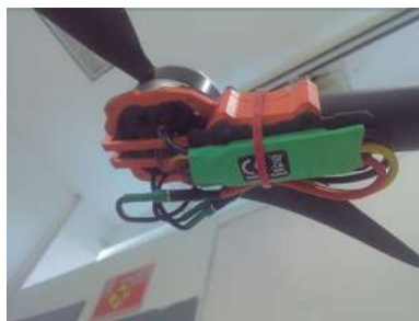
Figura 3.14: Montaje de motores MT4012 en el hexacóptero.
