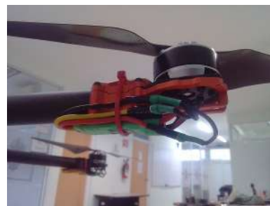
Figura 3.14: Montaje de motores MT4012 en el hexacóptero.
