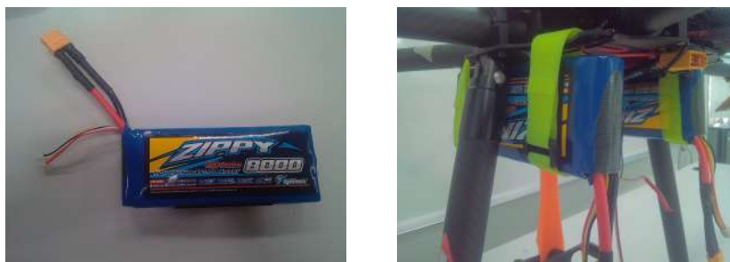
Figura 3.12: Baterías LiPo montadas en el vehículo.
