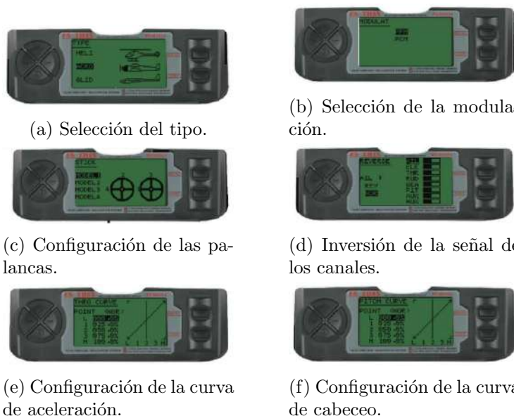
Figura 3.20: Configuraciones realizadas en el control remoto FS-TH9X.
