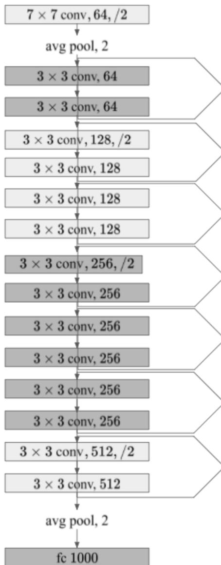
Figura 4.9: Diagrama de un ejemplo de ResNet. Imagen basada en [16].
